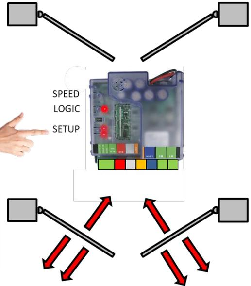
Une fois le **SETUP** terminé, les voyants A et B du "SETUP" doivent être éteint et **le portail doit être en position ouvert.**
