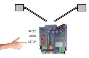
Le portail doit effectuer une manœuvre d'<u>ouverture</u> puis de <u>fermeture</u> au ralenti, puis une manœuvre d'<u>ouverture</u> à pleine vitesse.
