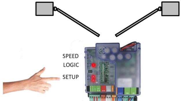
Le portail doit effectuer une manœuvre d'ouverture puis de fermeture au ralenti, puis une manœuvre d'ouverture à pleine vitesse.
