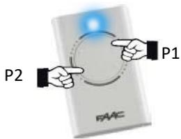
Sur la télécommande Appuyer en même temps sur **P1** et **P2**, l'émetteur se met à clignoter, relâcher les deux boutons, l'émetteur continue à clignoter.
