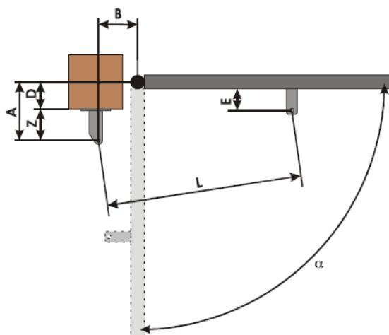
**La fixation avant du bras doit être posée sur la traverse renforcée**
